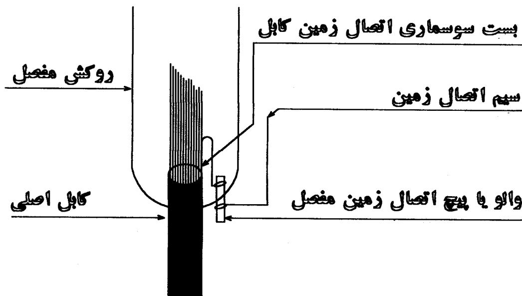
۲ - سر دیگر سیم زمین مفصل را با استفاده از سه راهی انشعاب سیم زمین که جنس آن از مس و دارای روکش پلی اتیلن می باشد (کلیپ مارکوس) به سیم مفتولی هفت لای نمره ۶ با روکش پلی اتیلن که قبلاً در قسمت فوقانی چشممه های آهنکشی اطاق کابل نصب گردیده و مستقیماً به زمین اصلی مرکز متصل می باشد وصل می نمائیم. به ترتیبی که ابتدا حدود ۴ الی ۵ سانتیمتر از روکش سیم مفتولی نمره ۶ را برداشت (به اندازه طول کلیپ مارکوس) و سپس با قراردادن سه راهی انشعاب روی سیم زمین نسبت به اتصال سیم زمین مفصل اقدام می گردد.(مطابق شکل)
